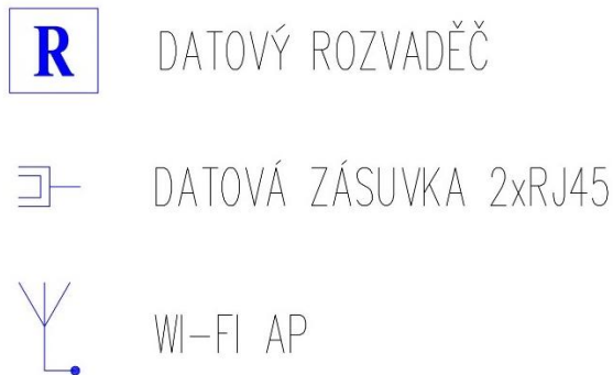
Obrázek 30 Značení pro datovou infrastrukturu a Wi-Fi (Zdroj: Vlastní zpracování)
