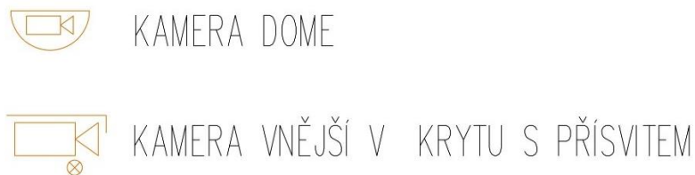
Obrázek 31 Značení pro CCTV (Zdroj: Vlastní zpracování)
