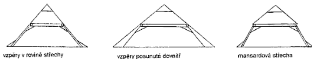
Obr. 3.2 Sklony vzpěr ležatých stolic
