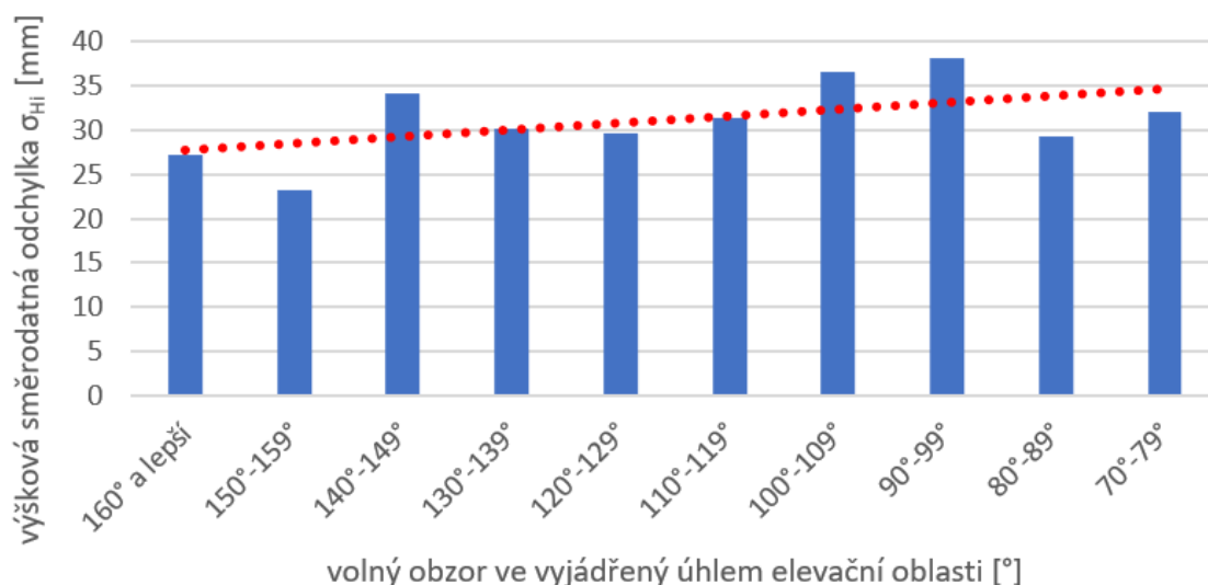
Obr. 10 Závislost přesnosti určení výšky na elevační oblasti.
