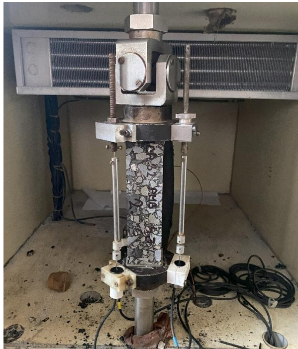
Obrázek 24. Zkušební vzorek uchycený k zatěžovacímu zařízení
