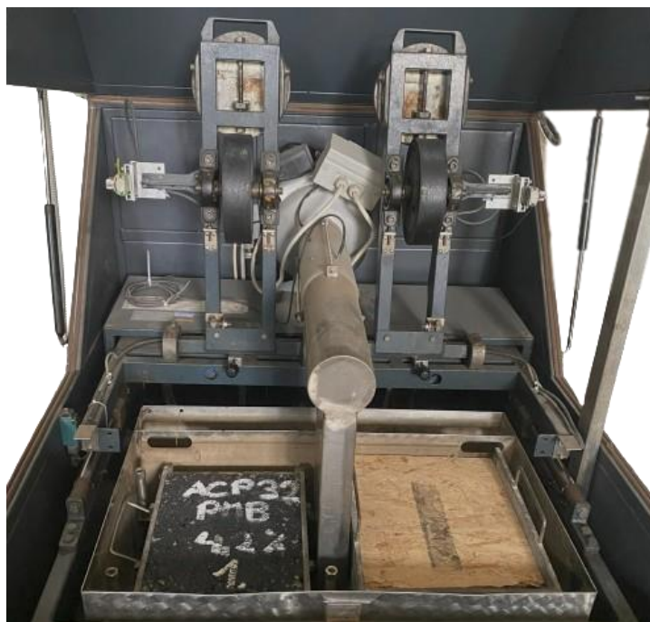
Obrázek 25. Deska umístěna v zařízení simulující pojíždění kolem
