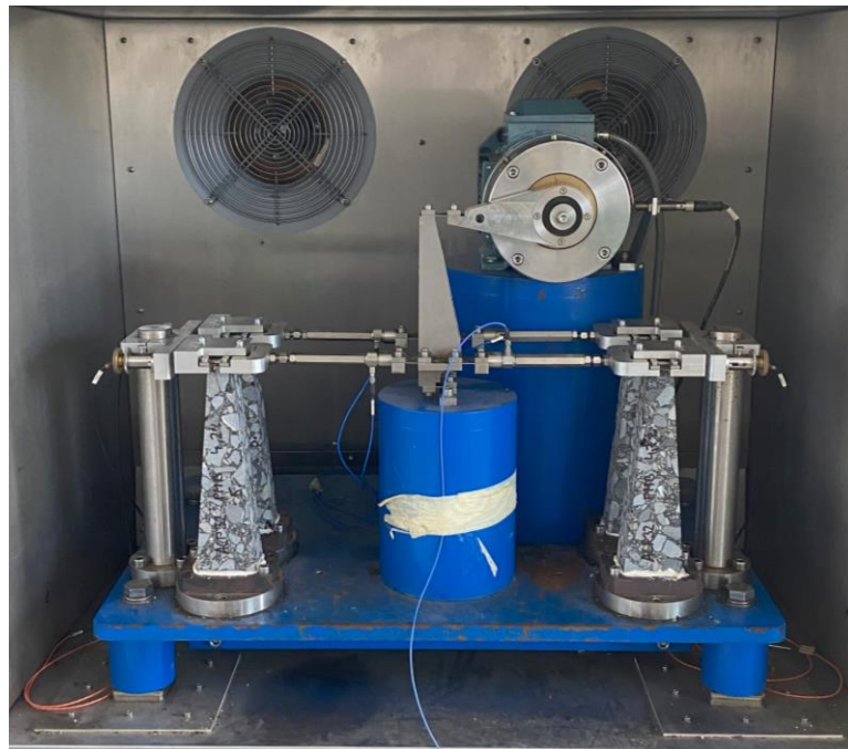
Obrázek 21. Upevněné zkušební vzorky v termostatické komoře
