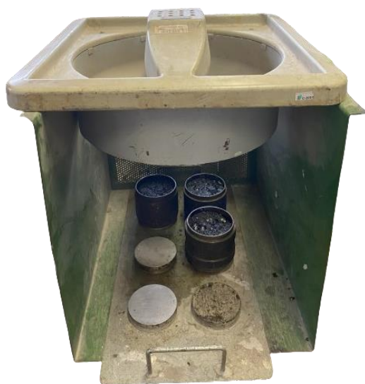
Obrázek 28. Chlazení Marshallových těles pod větrákem
