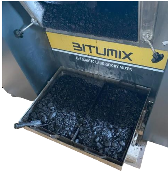
Obrázek 31. Asfaltová směs ACP 32 v míchacím zařízení
