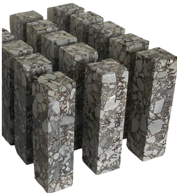
Obrázek 23. Nařezané a následně obroušené zkušební trámečky
