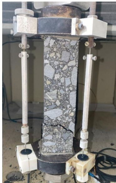
Obrázek 33. Porušené zkušební těleso po zkoušce TSRST
