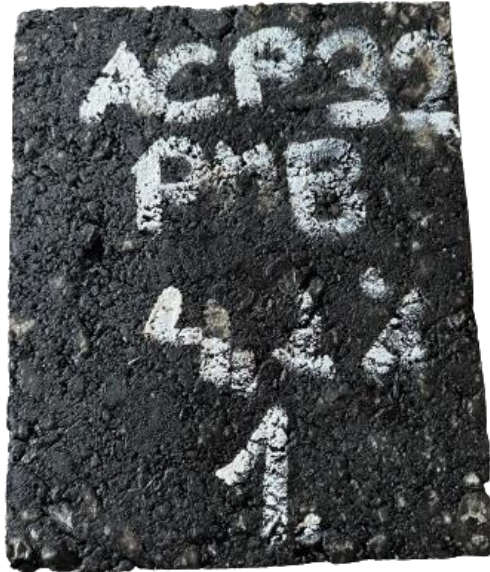
Obrázek 34. Zkušební deska po 10 000 zatěžovacích cyklech
