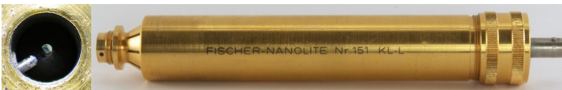
Obr. 3.13 Nanosekundové jiskřiště Fischer-Nanolite Nr. 151 KL-L.
