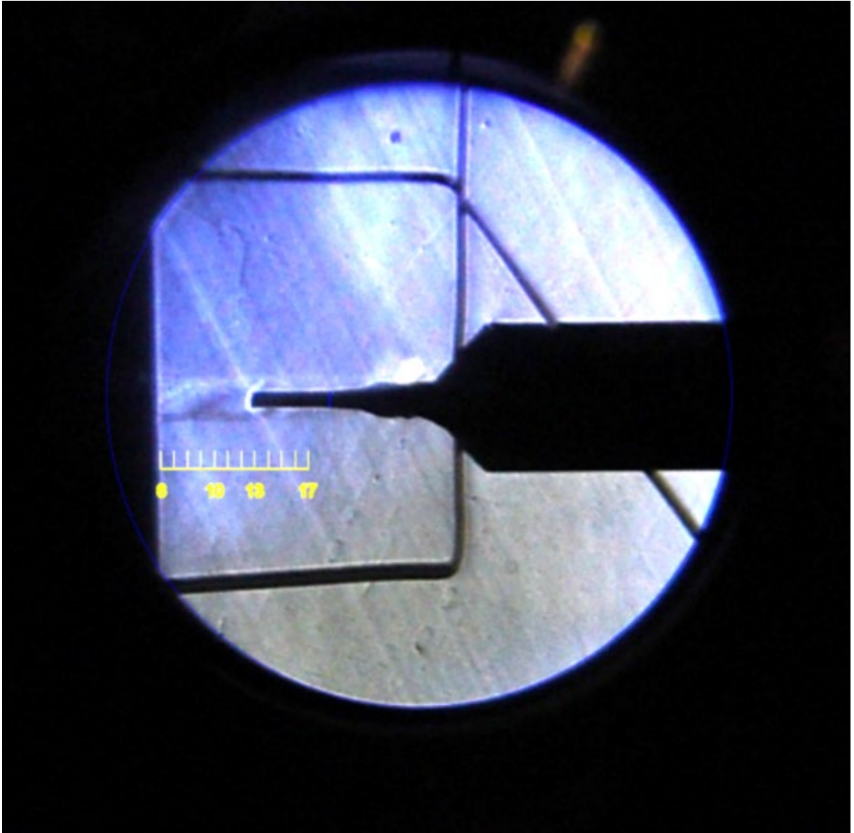
Obr. C.65 Experimentální zobrazení tlakových gradientů pomocí optických metod s nižším rozlišením pro variantu 75 000 Pa se zasunutou sondou.
