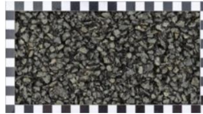
Obr. 8 Tenký asfaltový povrch (VTAC) 0/6 [20]
