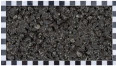
Obr. 7 Kamenný tmelový asfalt (SMA) 0/10 [20]
