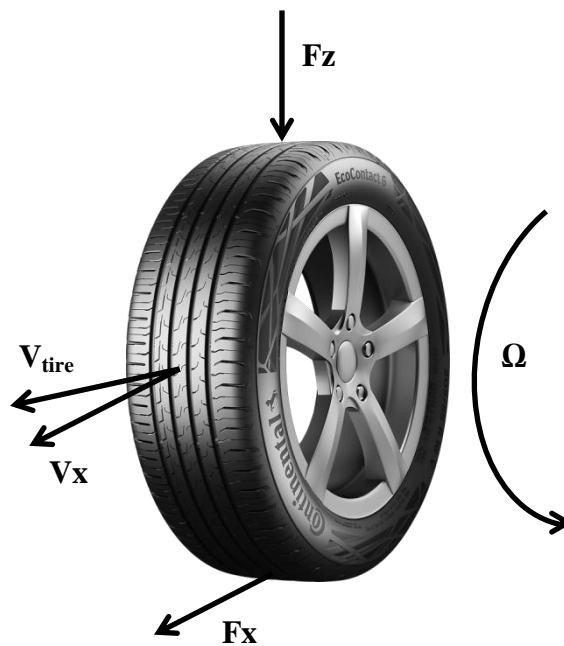
Obr. 20 Schéma rozložení sil a rychlostí na kole vozidla [58]
