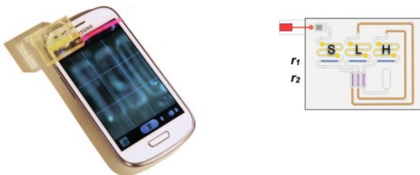
Obrázek 17: Mikrofluidní lab-on-chip pro měření koncentrace glukózy ve vzorku. Zdroj: [3]
