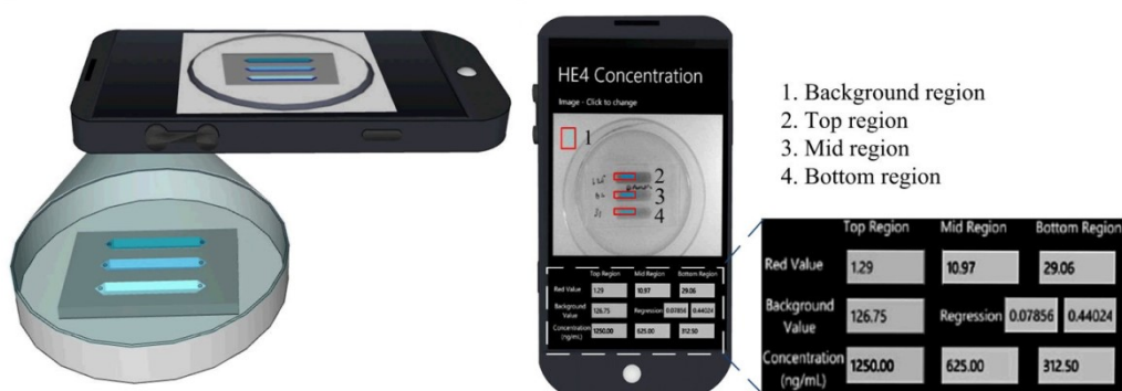
Obrázek 14: Vyhodnocení ELISA pomocí mobilního telefonu. Vlevo ilustrace snímání, vpravo uživatelské rozhraní mobilní aplikace. Zdroj [23]
