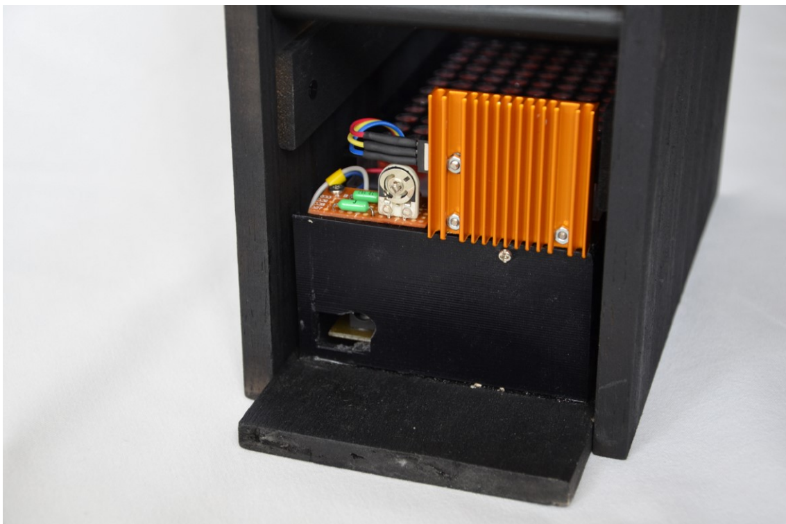
Obrázek 39: Pohled na odkrytou bázi aparátu s oranžovým pasivním chladičem napěťového stabilizátoru. Po jeho levé straně se nachází odporový trimr. Výřez dole vede k DC konektoru osvětlovací jednotky.
