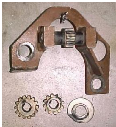
Obr. 33 JOHN DEERE - Nástroj pro plynulý posun kola po poloose [25]
