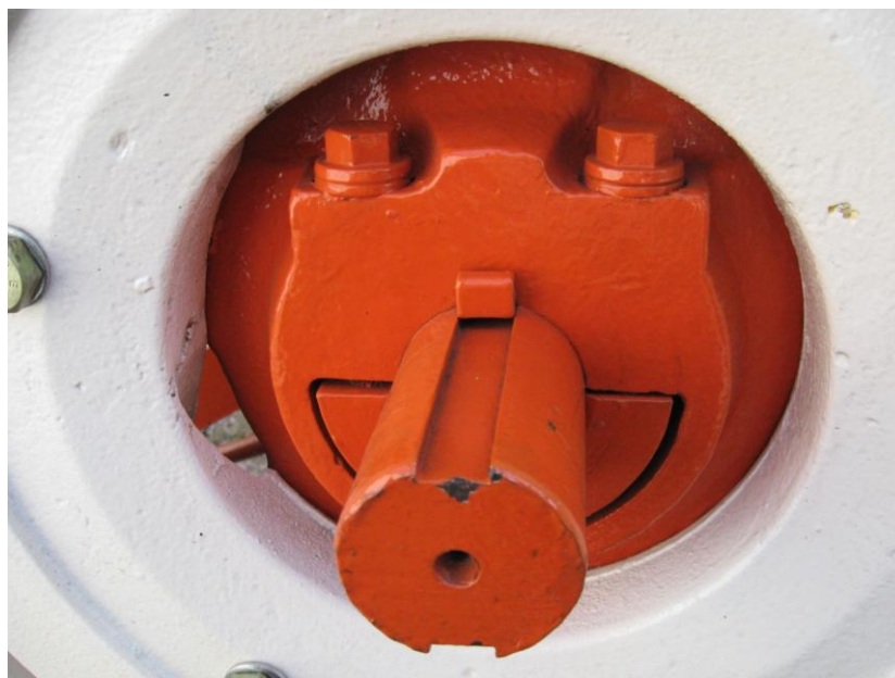
Obr. 36 ZETOR 25 A - Nastavitelný rozchod zadních kol
