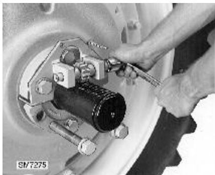
Obr. 32 JOHN DEERE – Plynulé posouvání kola po poloose [24]
