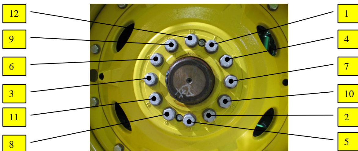
Obr. 22 Litinový disk kola s 12 šrouby – JOHN DEERE – 7280R
