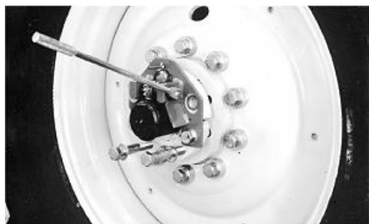
Obr. 19 Posouvání zadního hnacího kola po polonápravě s použitím nástroje ⑤ [18]
