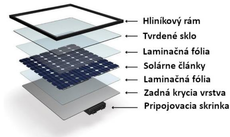
Obrázok 4 Štruktúra solárneho panelu [11]
