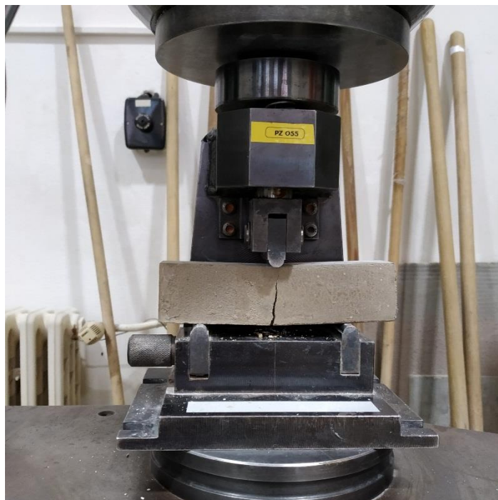
Obrázek 11: Porušení zkušebního tělesa při zkoušení pevnosti v tahu za ohybu
