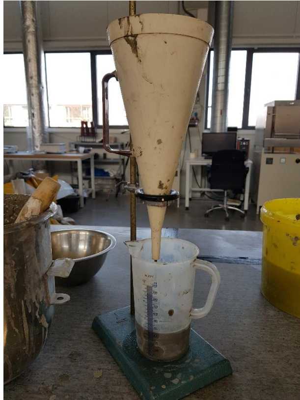
Obrázek 15: Měření doby průtoku Marshovým kuzelem
