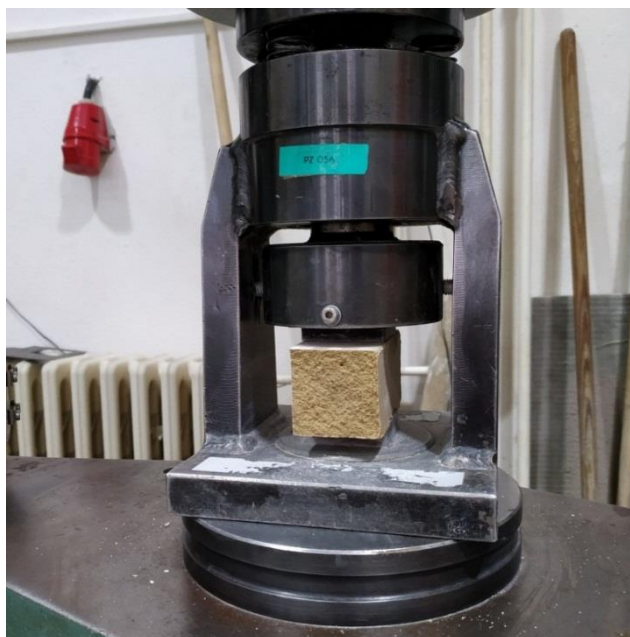
Obrázek 21: Přípravek pro zajištění tlačné plochy 40x40 mm při zkoušení pevnosti v tlaku
