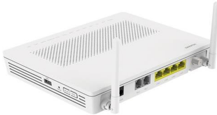
Obrázek 49: ONT Huawei HG8247H
