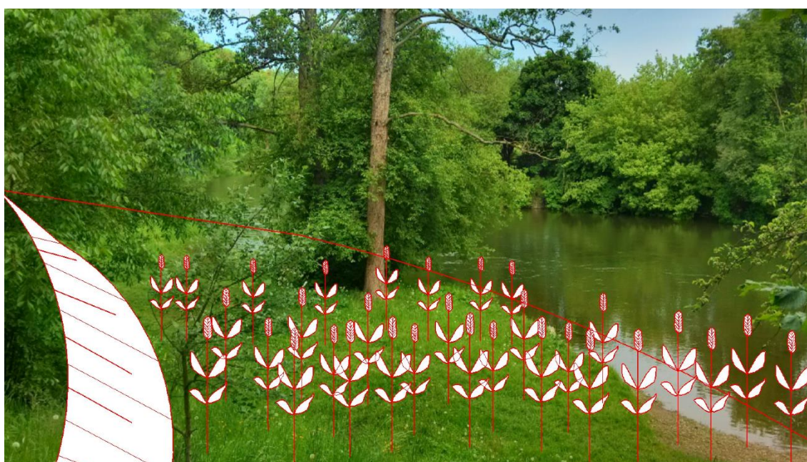
Obr. 9.1d Konvexní břeh s návrhem bermy a zóny rákosin (Svratka 1)
