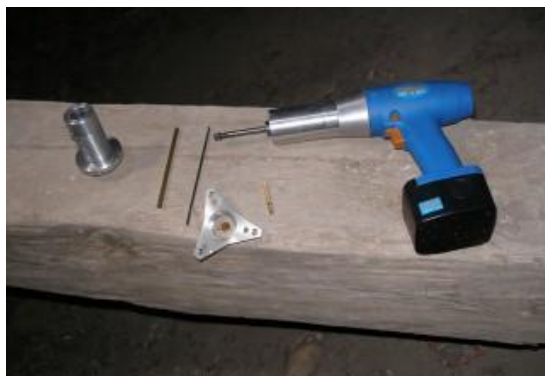
Obr. 4.6: Vybavení pro odběr radiálního vývrtnu [11]
