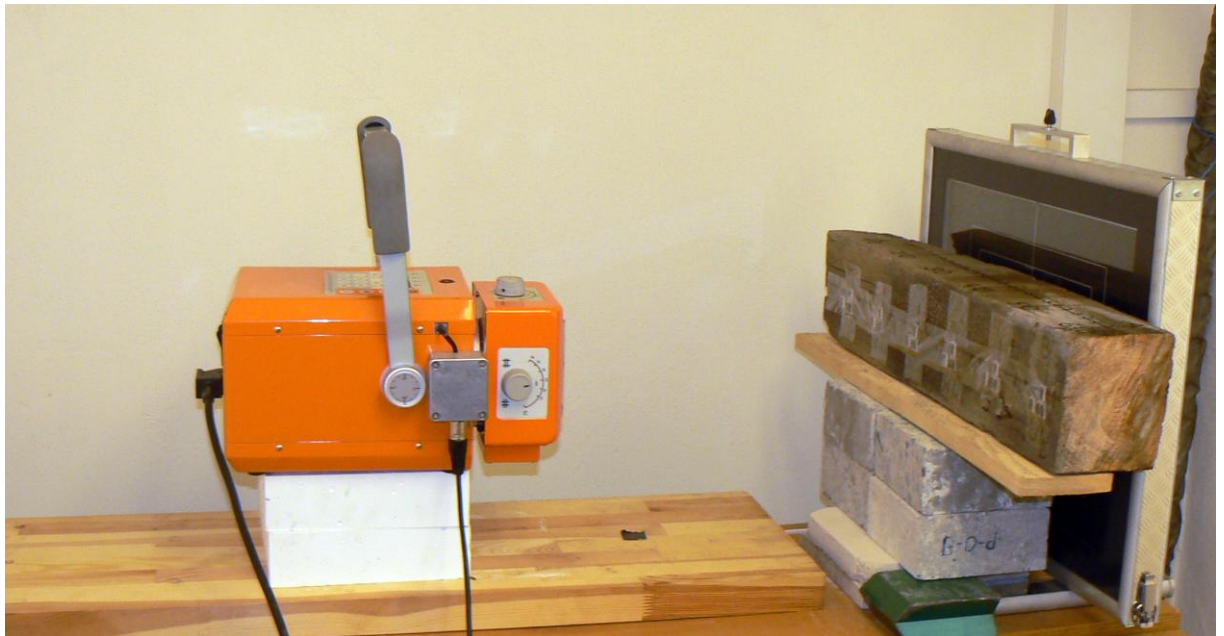
Obr. 5.57: Prozařování fragmentu hambálku rentgenem EcoRay HF1040 s užitím bezdrátového zobrazovacího panelu Aero DR.
