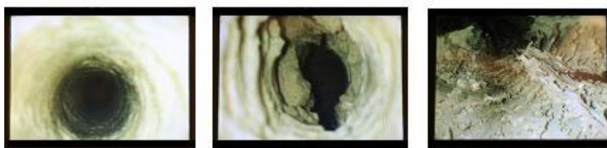
Obr. 4.8: Obrázek získaný pomocí přístroje Videoprobe XL PRO z jednotlivých vrtaných sond [11]
