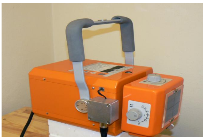
Obr. 5.55: Rentgen EcoRay HF1040. Přístroj původně určený pro veterinární lékařství, ale svou mobilitou a výkonem ideální pro terénní prozařování dřevěných konstrukcí.
