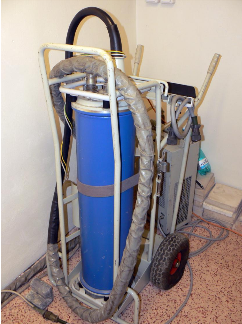
Obr. 5.58: Starší rentgen Andrex CP160. Přístroj je hmotný a rozměrný, pro prozařování v terénu sice použitelný, ale s řadou omezení.
