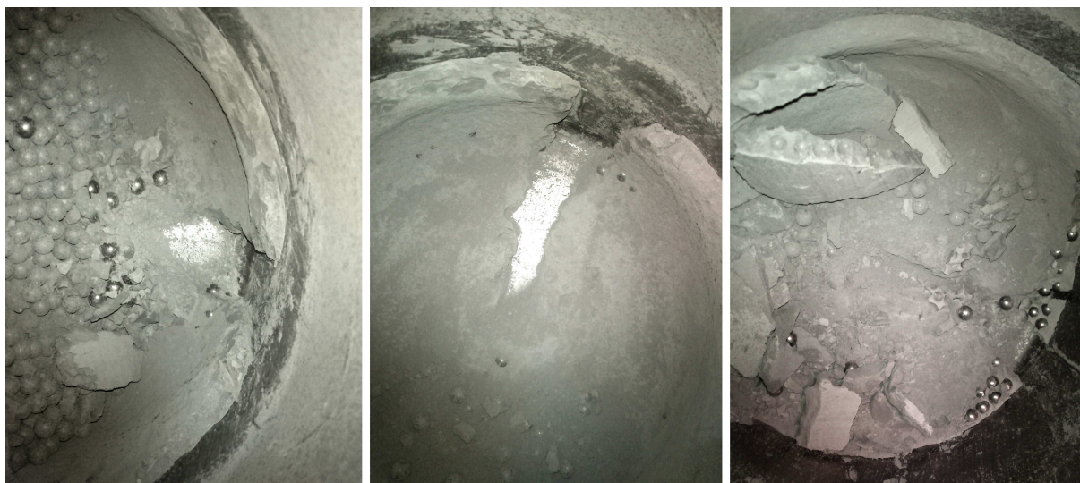
Obr. 11: Korund na stěnách a dně mlýna pro názornost v různých stádiích čištění mlýna
