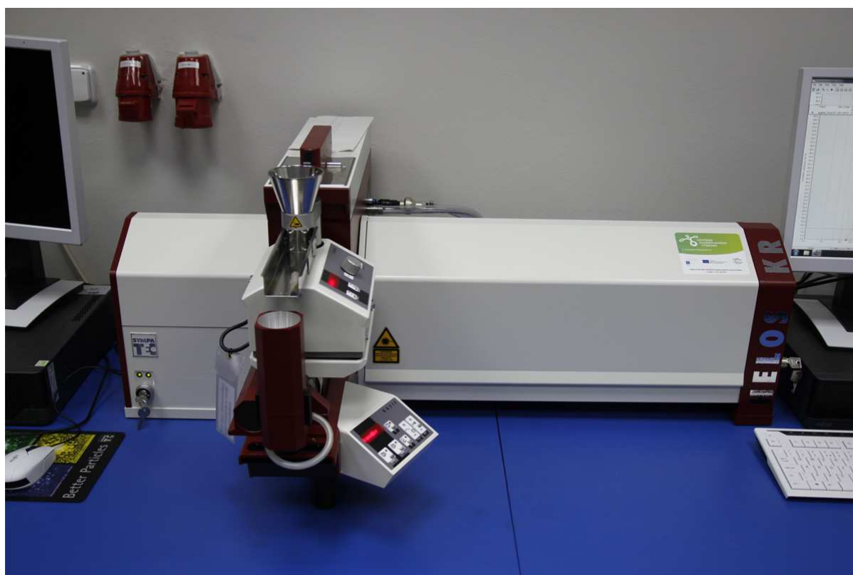
Obr. 12: Celkový pohled na laserový analyzátor velikosti částic Sympatec HELOS KR
