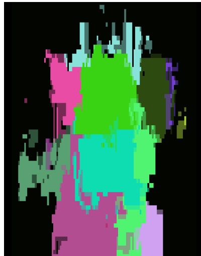
Obrázek 7.10: Výsledky segmentace metodou rozvodí s mediánovým filtrem, hladina prahování rovna 0,1, hodnota hladiny rozvodí rovna 0,02, jádro o délce hrany 11, F-Measure rovna 0,40928
