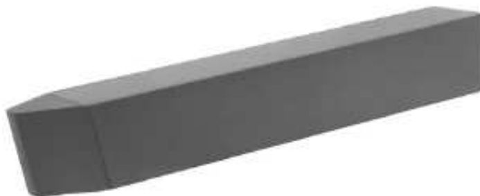
Obr.8.1 Nůž na klínové drážky řemenic 17
