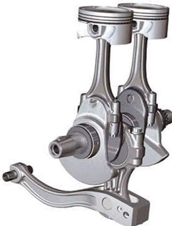
Obr. 7 Vyvážení pomocí pákového mechanismu v motoru BMW [3]
