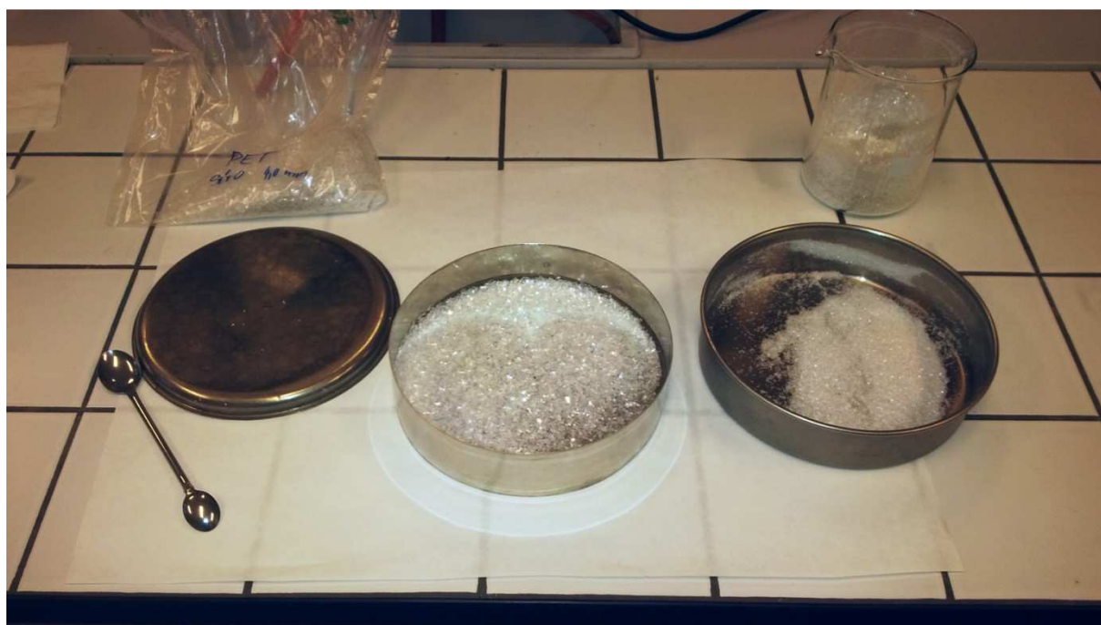
Obr. č. 6 - Průběh přípravy nosiče z odpadních PET lahví - sítování
