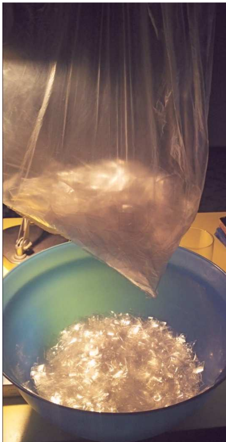
Obr. č. 5 - Průběh přípravy nosiče z odpadních PET lahví - předpříprava umytých odpadních PET lahví
