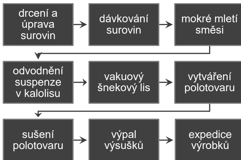
Obr. 7 – Schéma technologie výroby forsteritu tažením z plastického těsta
