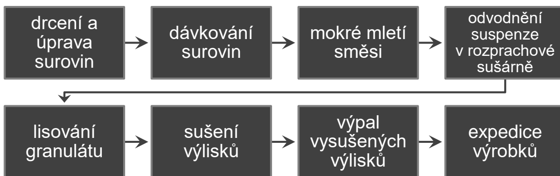
Obr. 8 – Schéma technologie výroby forsteritu lisováním z granulátu
