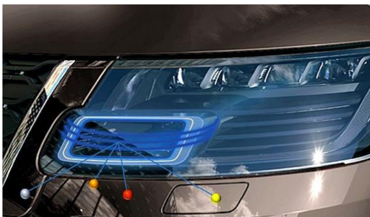
Obr. 2-15 Integrovaný lidar v LED světlech [32]
