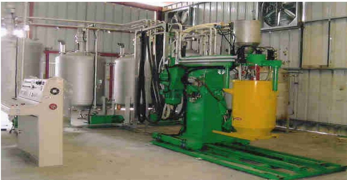
Obr. 5: SA-1BM - vypěňovací stroj na výrobu pěnových bloků (21)
