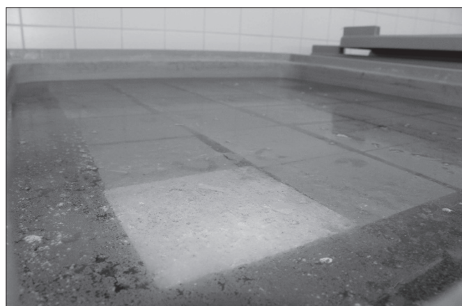
Obr. 1 Zrání betonu ve vodním uložení – standardní voda z vodovodního řádu (vlevo), použitá voda (vpravo). Fig. 1 Placing test specimens into water; on the left standard water; on the right used water.
