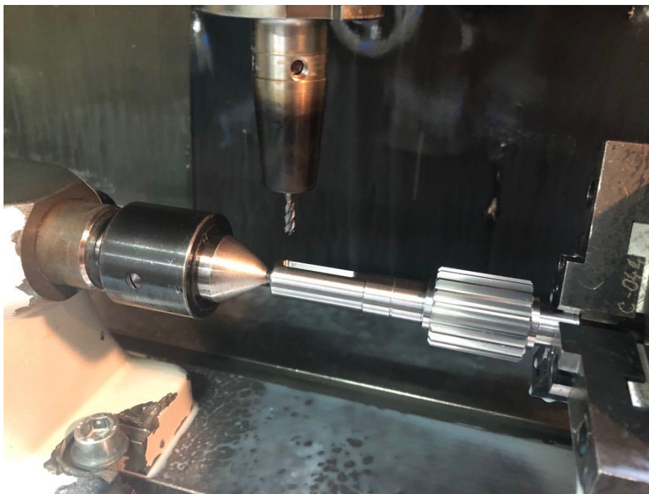
Obr. 6.4 Vyfrézování drážky pro pero.
