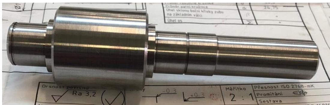
Obr. 6.1 Součást po osoustružení válcových ploch.
