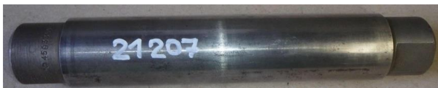
Obr. 3.12 Samosvorný upínací kuželový trn [40].
