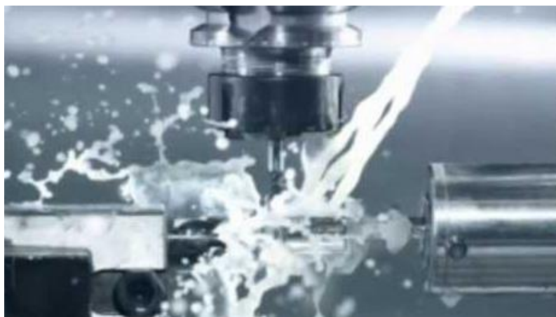
Obr. 3.14 Ukázka procesní kapaliny při obrábění materiálu [43].
