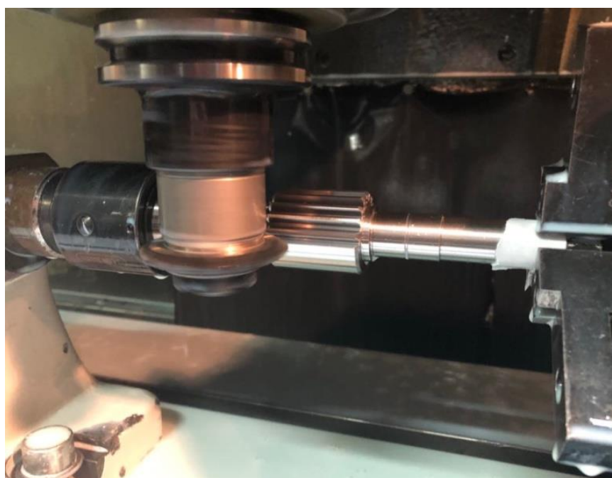
Obr. 6.3 Frézování zubové mezery na vertikálním obráběcím centru.
