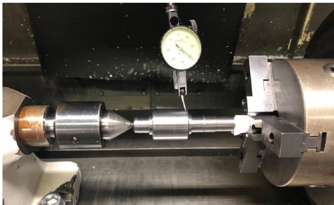
Obr. 6.2 Seřizování stroje MCV 750.
