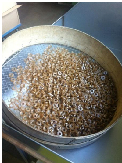
obr. 33 Zavedení síta při výrobě difuzoru
