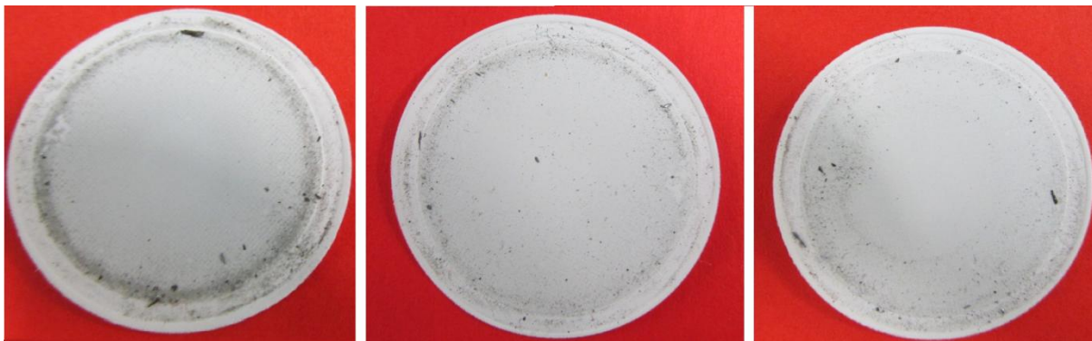
obr. 27 Výsledky testu čistoty po procesu šroubování filtru a fitinek
