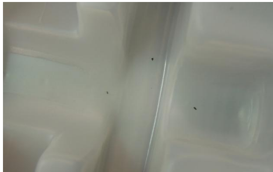
obr. 25 Znečištění prokladu od proporcionálních ventilů
