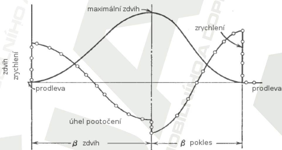
2.38, Zrychlení DRRD vaček různého typu s nesouměrným zdvihem, [5]
