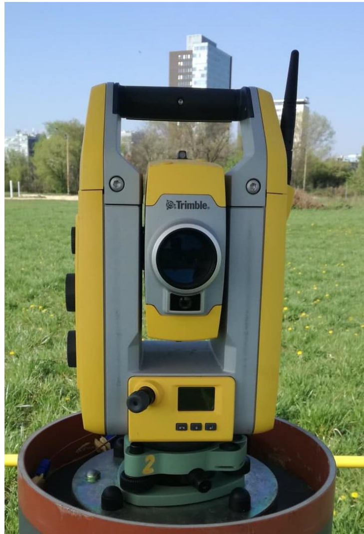
Obr. 3.3 Ukážka robotickej totálnej stanice Trimble S5
