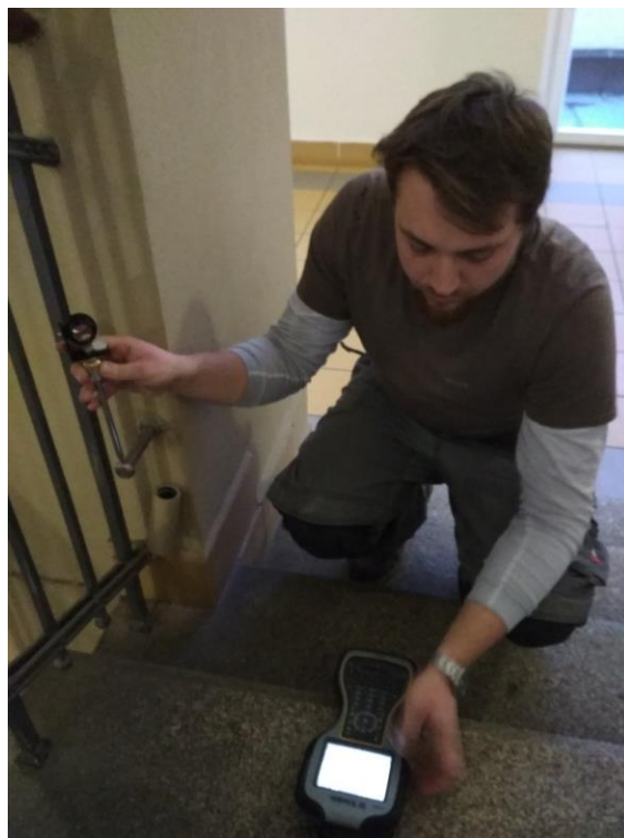
Obr. 3.8 Ukážka merania prevýšenia pomocou monitorovacieho hranola na kalibračnej základni
