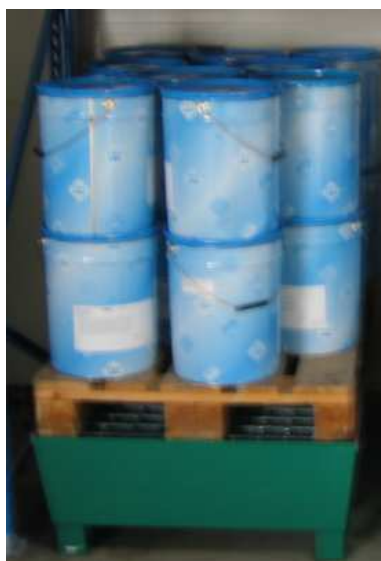
Obr. 34 Uskladnění nebezpečných látek v lakovně.
