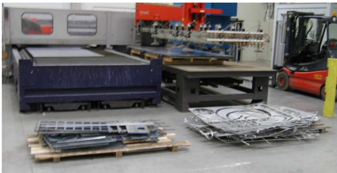
Obr. 26 Laserové pracoviště bez označené pracovní zóny
