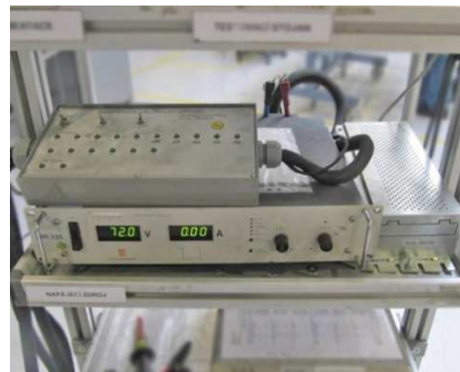
Obr. 41 Ovládací pult, řídicí jednotka a síťový zdroj
