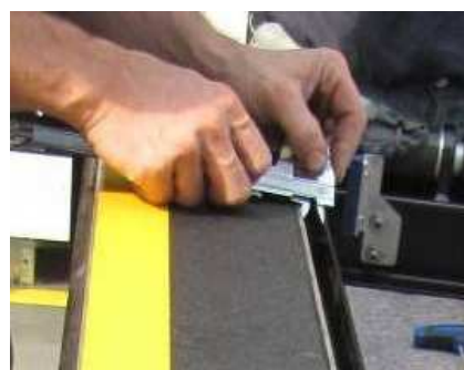
Obr. 28 Kontrola vzdálenosti schodnice od zadní strany rámu
