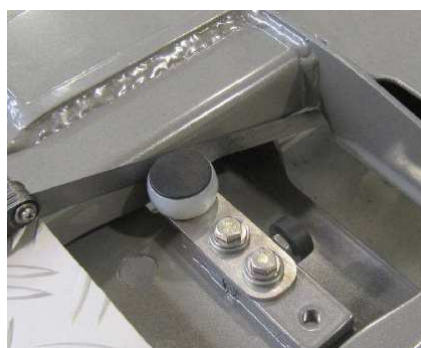
Obr. 29 Kontrola přednastavení stranových vodících kladek
