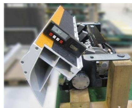
Obr. 31 Kontrola přednastavení úhlu sklopení schodnice
