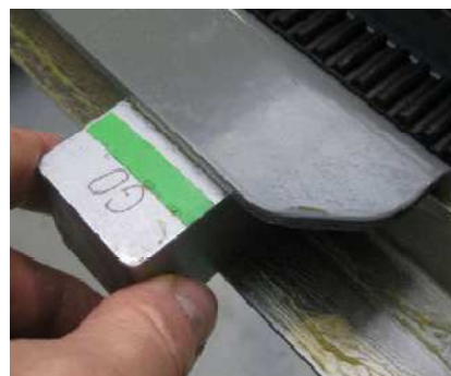
Obr. 26 Kontrola přednastavení vodících lišt pomocí přípravku
