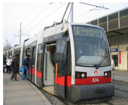
Obr. 6 Vozidlo s typem dveří sliding plug door [1]
