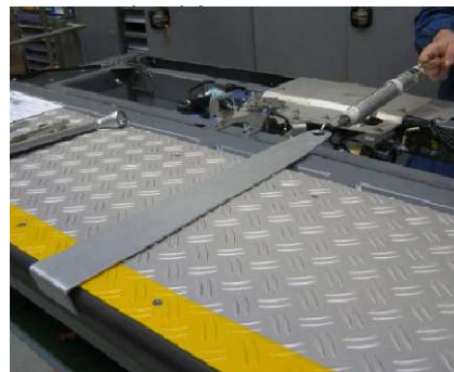
Obr. 38 Kontrola posuvné síly
