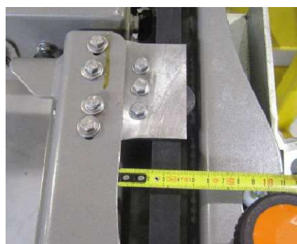
Obr. 27 Kontrola vystředění schodnice v ose výsuvu
