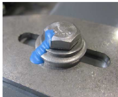
Obr. 44 Příklad správného seznačení šroubového spoje
