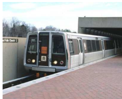
Obr. 5 Vozidlo s typem dveří sliding door [1]
