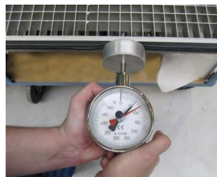
Obr. 42 Kontrola funkčnosti kontaktní lišty
