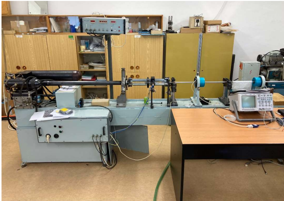
Obr. 12 Hopkinsonův tlakový test.
