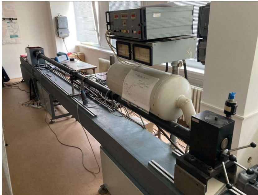
Obr. 8 Taylorův kompresní test v laboratoři vysokých rychlostí deformace.
