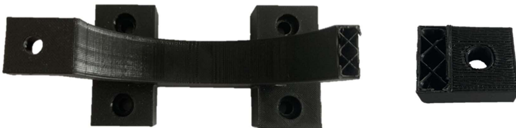
Obr. 60 Prasknutý díl vyrobený technologií 3D tisku.
