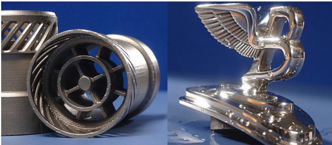
Obr. 21 Ukázka hrubého opracovaného odlitku (vlevo) a opracovaného odlitku [9]
