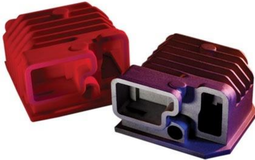
Obr. 24 Ukázka součásti vyrobené metodou Castform [43]
