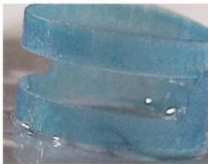
Obr. 8 Součást s rozpuštěnou podporou [3]
