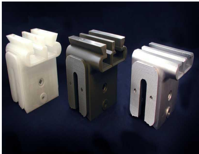
Obr. 25 Ukázka součásti vyrobené metodou Repliwax [44]
