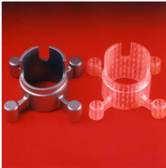
Obr. 23 Ukázka součásti vyrobené metodou Quickcast [42]
