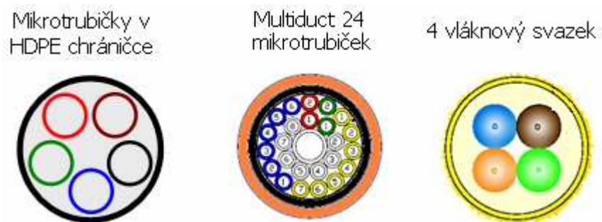
Obr.2.7: Příklady pasivních prvků pro budování distribuční infrastruktury [7].
