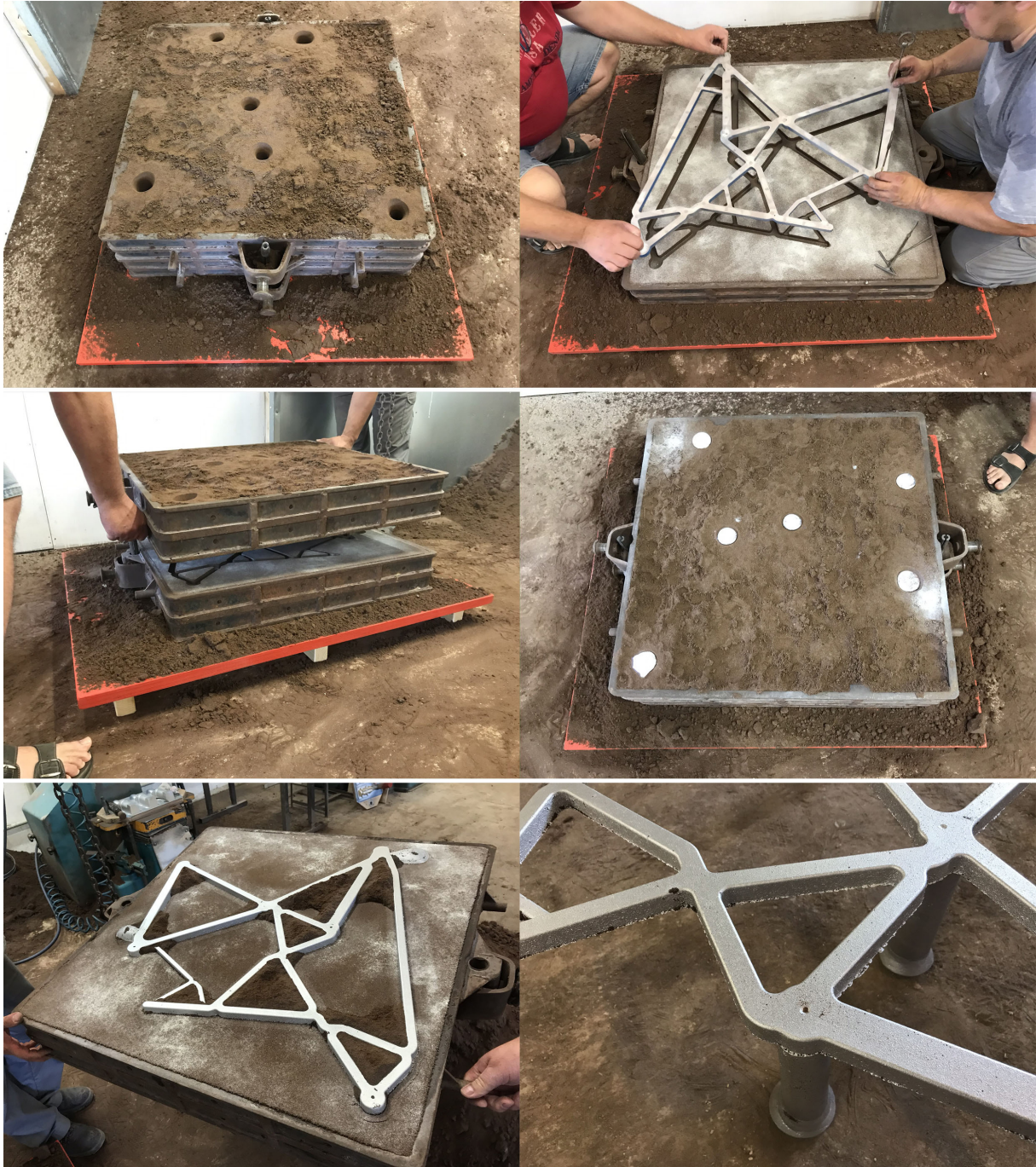
Obr. 12.: Dokumentace výrobního procesu – výroba pískové formy a odlévání
