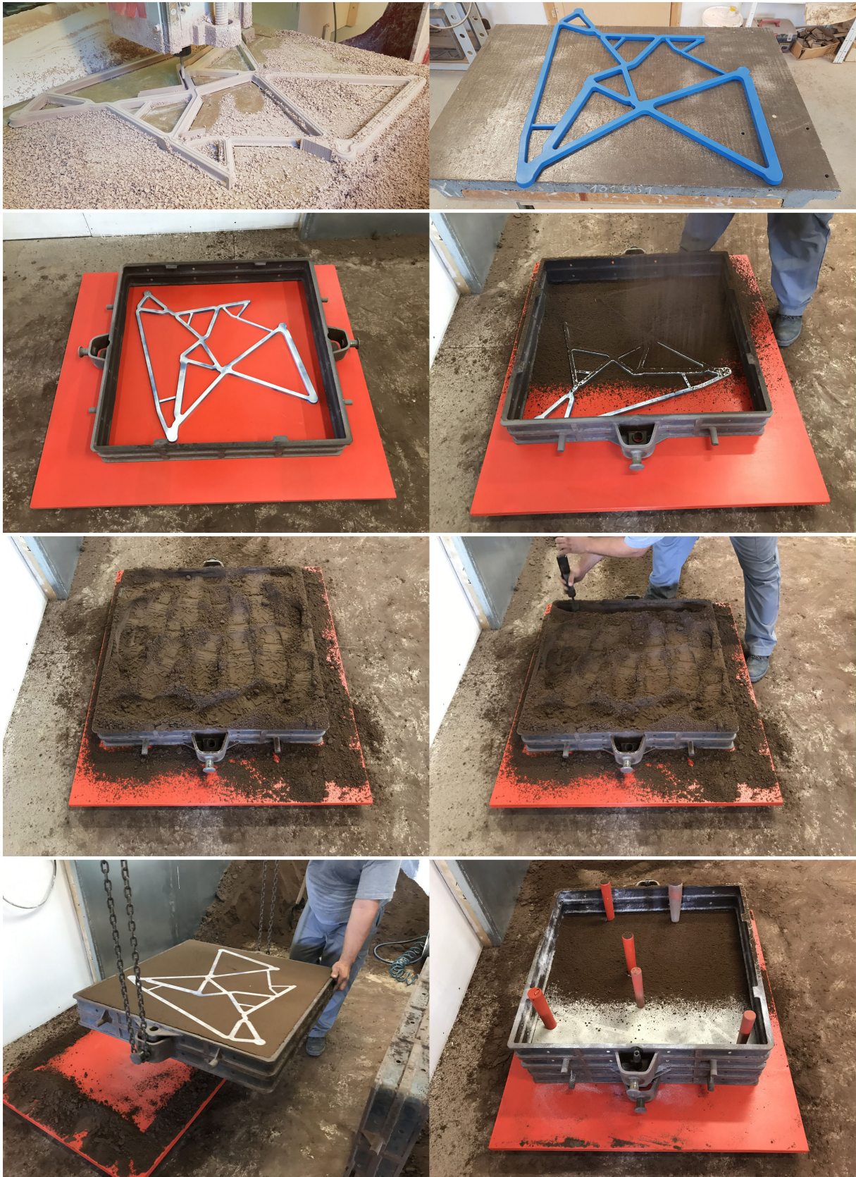
Obr. 11.: Dokumentace výrobního procesu – výroba pískové formy a odlévání
