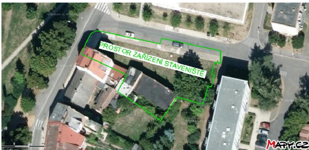
Obrázek H.1 – Prostor zařízení staveniště (zdroj [3])
