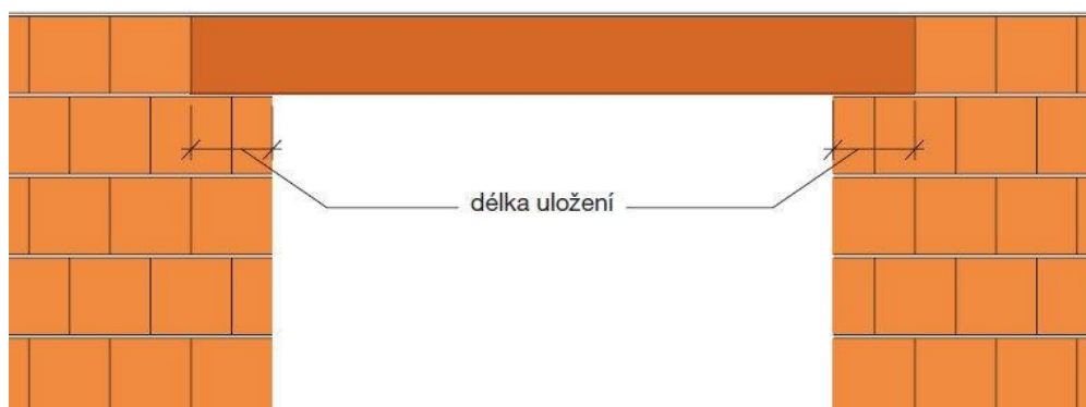
Obrázek D.7.1.5 – Délka uložení překladu (zdroj [4])
