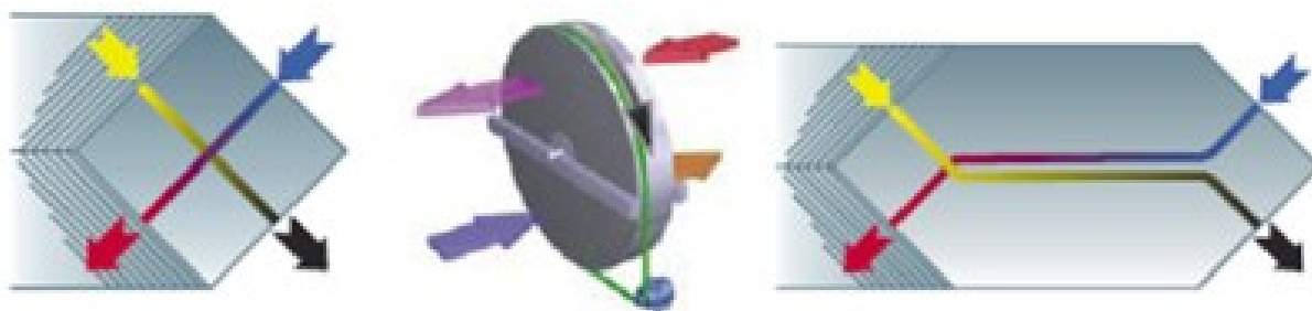
Obr. 3.5: Výměník křížový (vlevo), rotační (uprostřed) a protiproudý (vpravo) [13]
