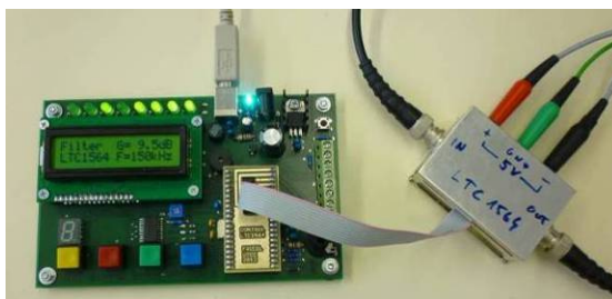
Obr. 4.33: Zrealizovaný filtr s vývojovým kitem.
