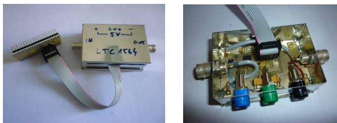
Obr. 4.29: Zrealizovaný digitálně řízený filtr s LTC1564.
