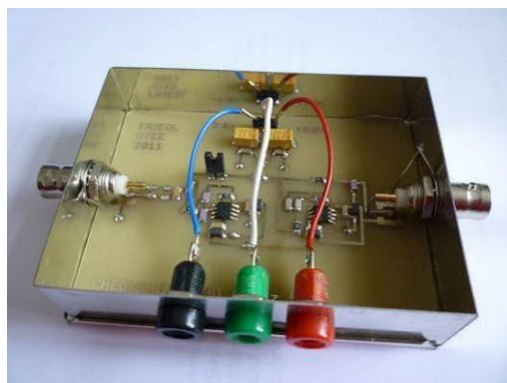
Obr. 4.12: Realizovaný ARC filtr s nulami přenosu a měřící pracoviště.
