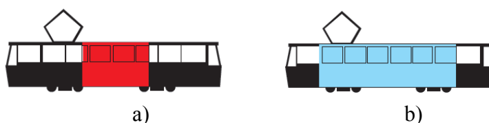
Obrázek 41: Umístění fólie způsobem a) "tramboard", b) "sideboard" [10]
