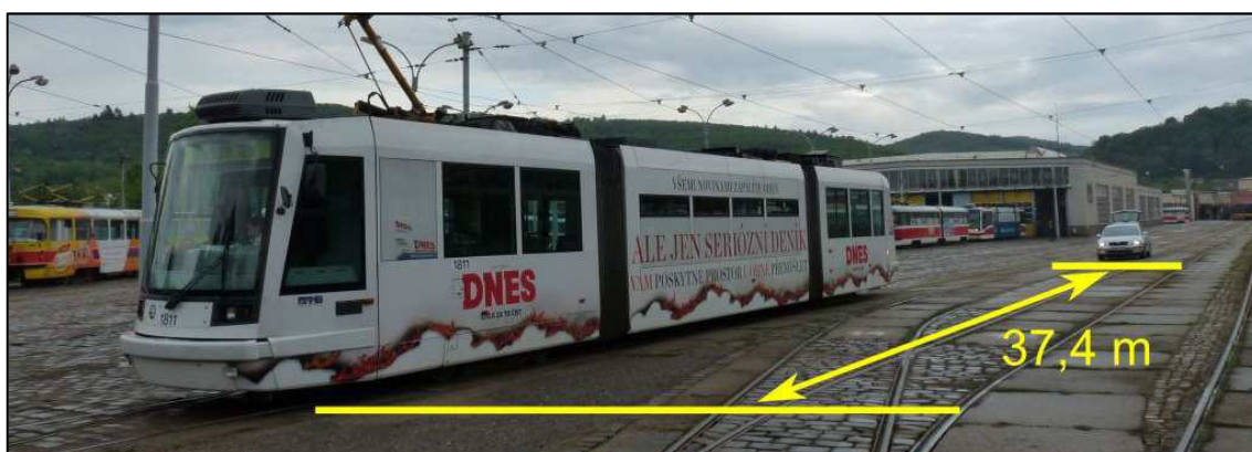
Obrázek 34: Konečná poloha tramvaje a vozidla při brzdění z výchozí rychlosti 64 km/h [15]
