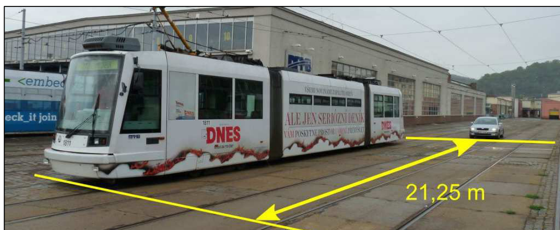
Obrázek 36: Konečná poloha tramvaje a vozidla při brzdění z výchozí rychlosti 50 km/h [15]
