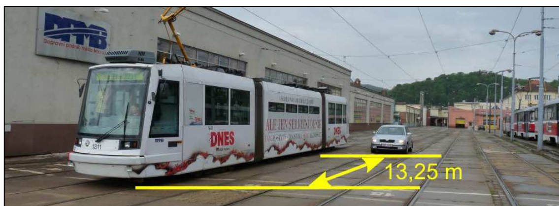
Obrázek 37: Konečná poloha tramvaje a vozidla při brzdění z výchozí rychlosti 43 km/h [15]
