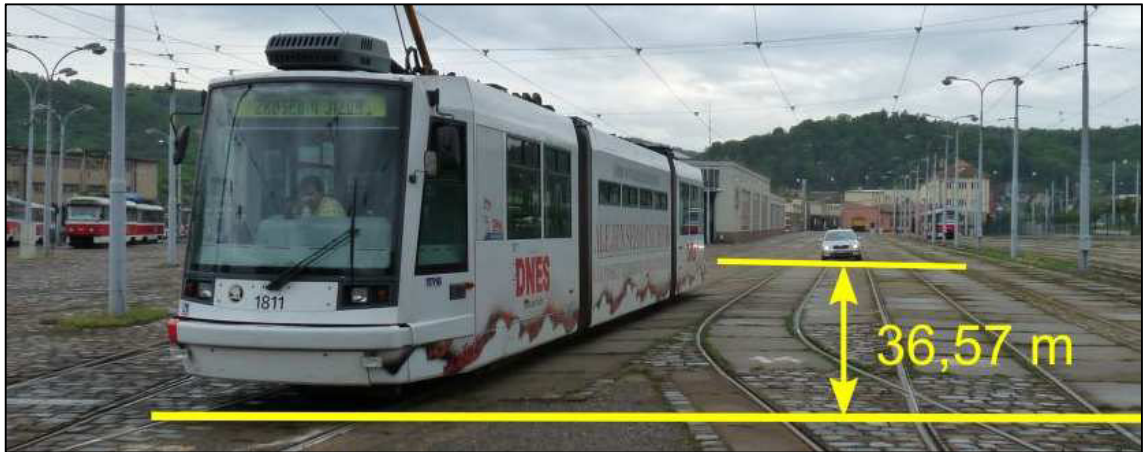
Obrázek 35: Konečná poloha tramvaje a vozidla při brzdění z výchozí rychlosti 61 km/h [15]
