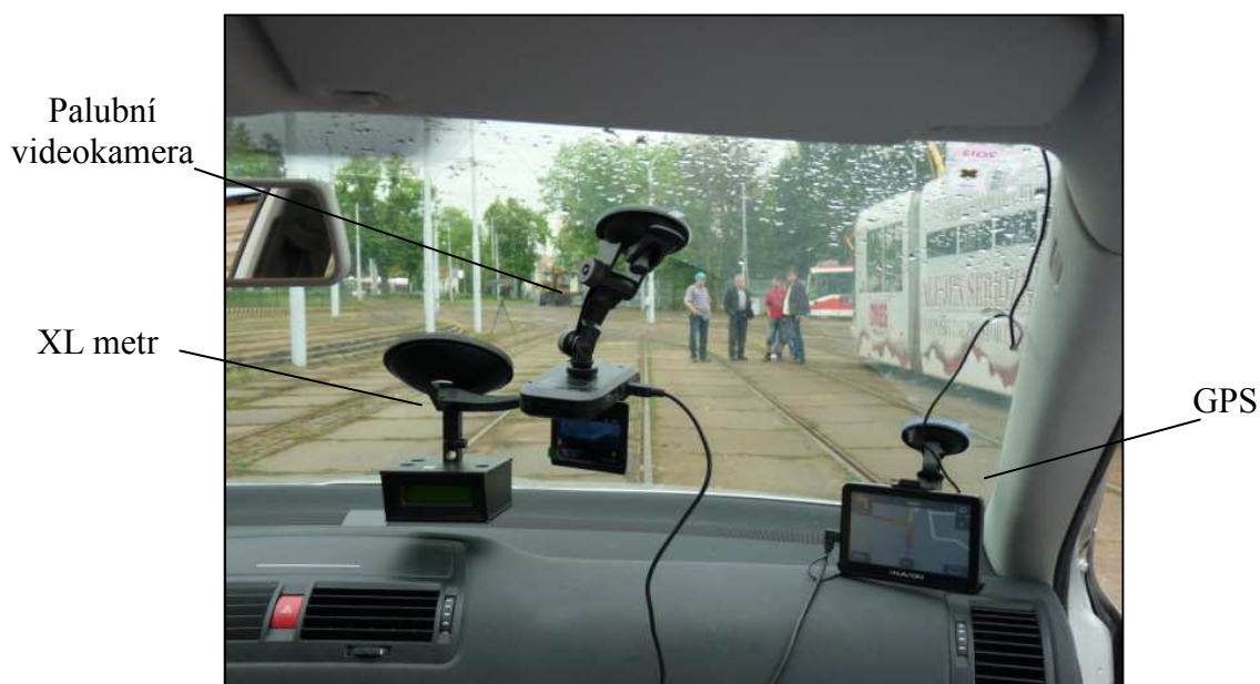
Obrázek 33: Umístění měřicích přístrojů v interiéru vozidla Škoda [15]
