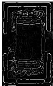
Obr. 20 – Výstupní obraz po provedení non-maximum suppression
