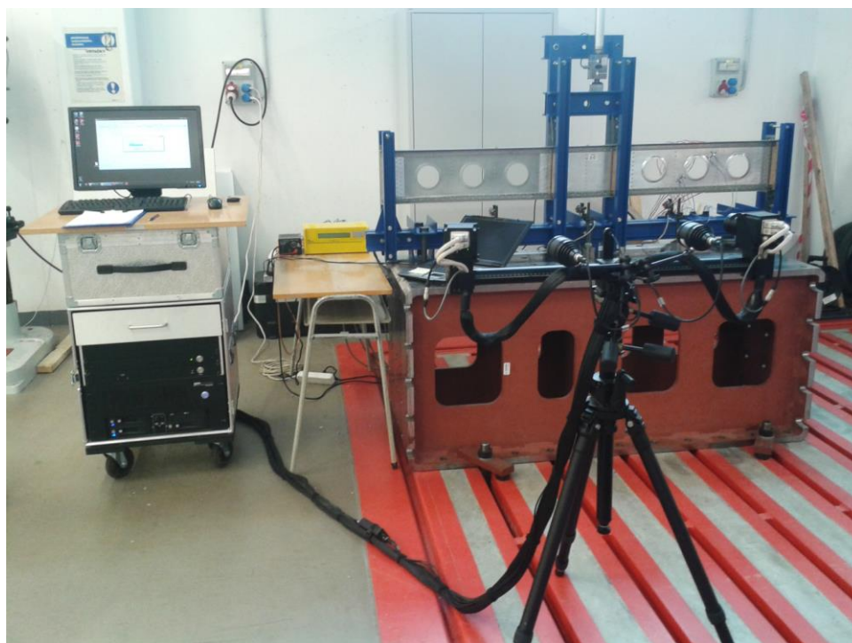
Obr. 4.15, Vzorek upevněný ve zkušebním rámu před zkouškou
