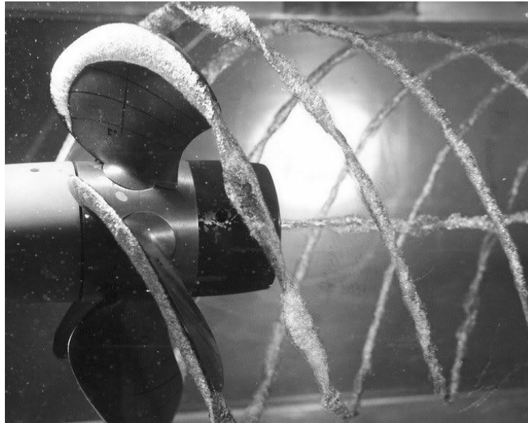
Obr. 1 Kavitácia na lodnej skrutke [3]
