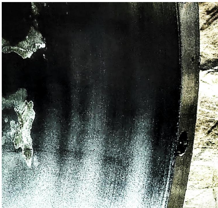
Obr. 22 Kavitačná erózia vnútornej steny bubna kavitačného ohrievača
