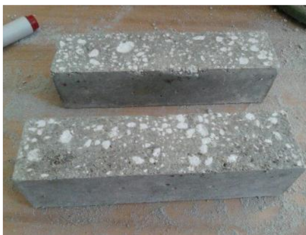
Obrázek 3 Shluky vápenatých produktů ve vzorku nakypřeném směsí chlorového vápna a peroxidu vodíku
