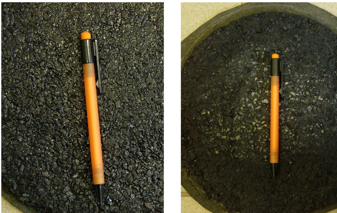
Obrázek 16 Zkušební těleso před zkouškou a po zkoušce opotřebení (vpravo) [30]
