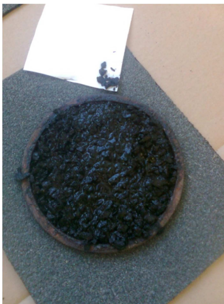
Obrázek 12 Zkouška konsolidace, filtrační papír [30]
