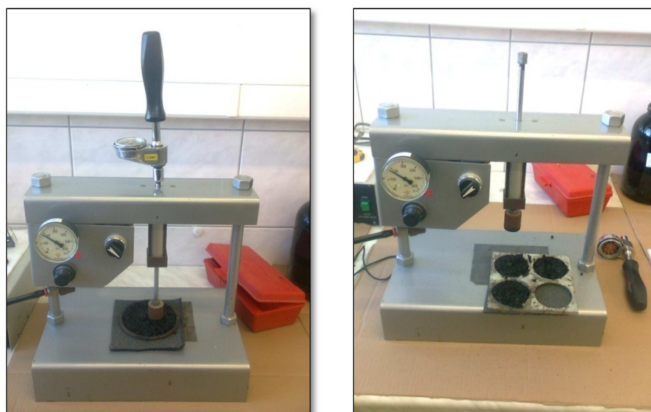
Obrázek 14 Zkušební přístroj pro stanovení koheze směsi se zkušebními vzorky [30]
