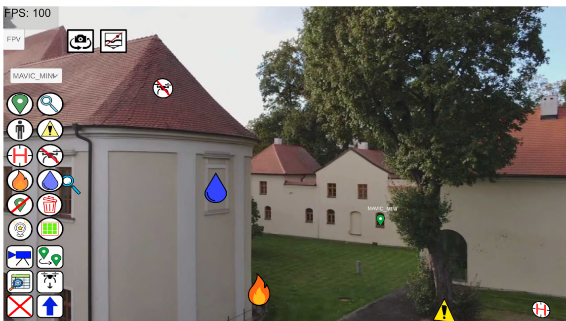
Obrázek 4.5: Ukázka FPV režimu v aplikaci velitele při vkládání ikony „Cílový bod“ pro dron Mavic Mini na konkrétní okno. Díky FPV pohledu lze ikonu umístit přesně na zamýšlené místo; nad ikonou se zobrazuje jméno vybraného dronu (na rozdíl od pilotovy aplikace, kde se u ikony zobrazuje vzdálenost). Pokud je ikona určena všem dronům, žádné označení nad ní není.
