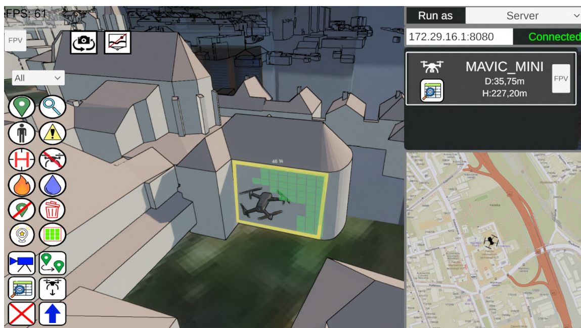
Obrázek 4.8: Zobrazení v aplikaci velitele s počátečním návrhem, kdy se buňky aktivovaly po prohledání a zbarvily zeleně. Na obrázku je 3D model dronu skenující budovu a v popředí záběr z jeho FPV kamery.
