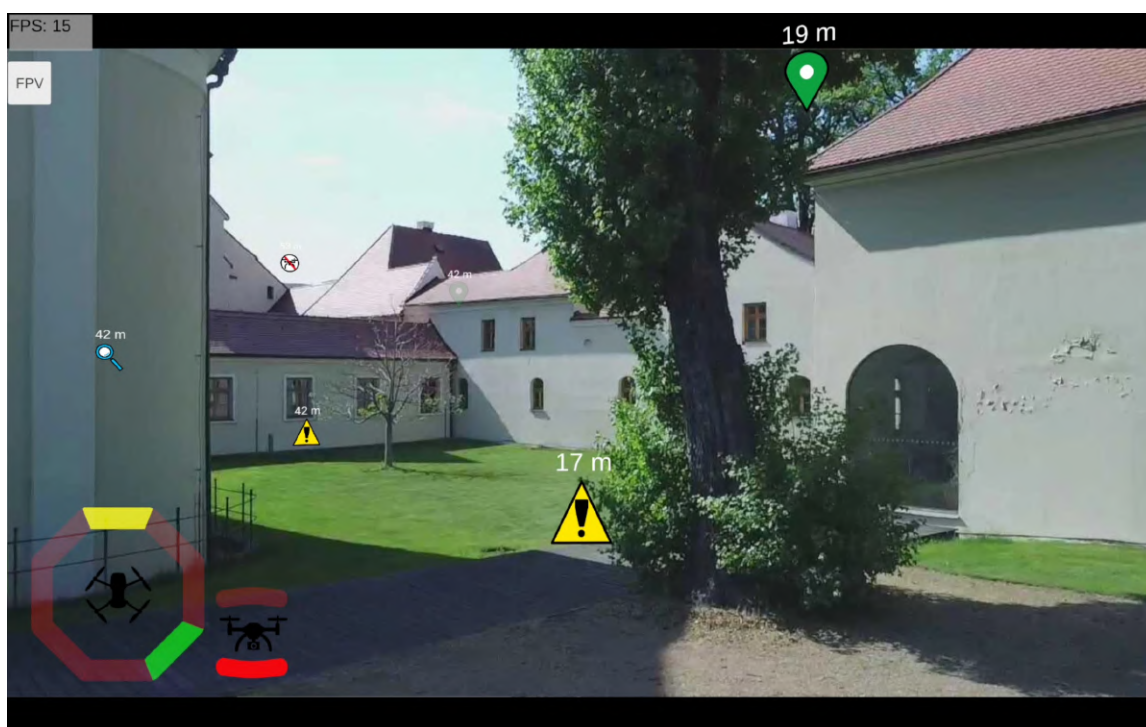
Obrázek 4.3: Pohled z aplikace pilota na vložené ikony za využití rozšířené reality.
