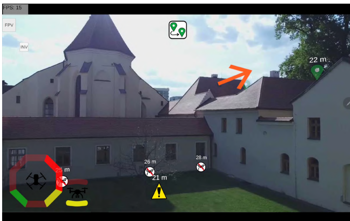
Obrázek 4.9: Zobrazení směrového ukazatele v aplikaci pilota. Šipka ukazuje na zvýrazněnou ikonu, jejíž zvýraznění bylo vyvoláno přijatou instrukcí (viditelnou v horní části obrazovky).
