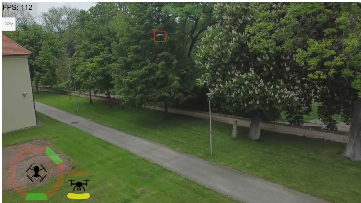
Obrázek 4.11: Zobrazení cizího dronu pomocí komponenty DroneMark v AR pohledu pilota.
