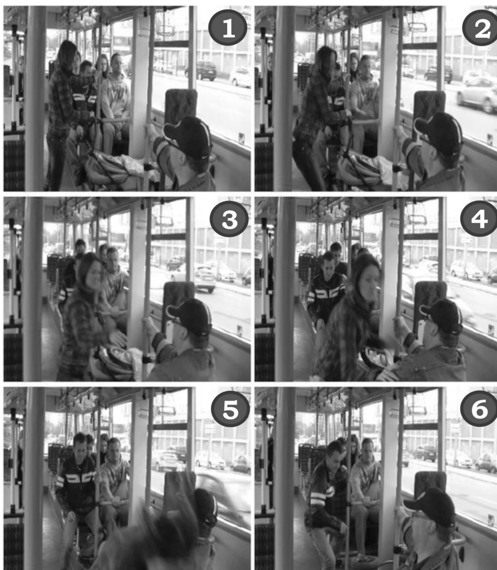
Obr. 3 Foto sekvence z jízdní zkoušky (zpomalení trolejbusu 6,03 \text{ m/s}^2 ).
