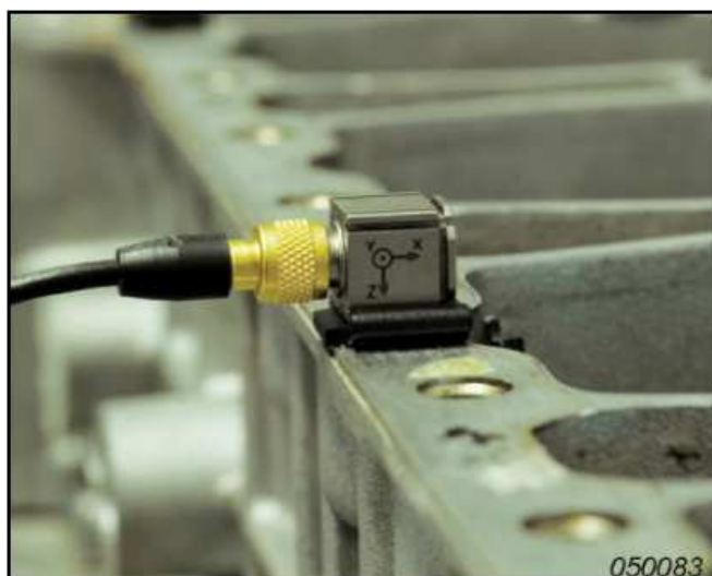
Obr. 26 Ukázka umístění akcelerometru B&K [9]
