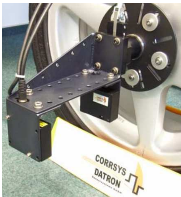
Obr. 28 Ukázka měření odklonu kola za použití dvojice senzorů Corrsys Datron HT-250 [11]
