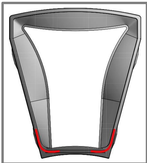
Obr. 3.14 Zvýrazněno problematické místo spoje tkaniny
