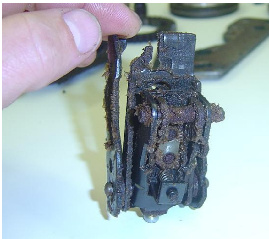
Obr. 3-5: Součást palivového čerpadla zaneseného úsadami [64]
