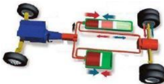
Obr. 5-23: Hydraulický systém rekuperace energie pomocí stlačeného vzduchu [31]
