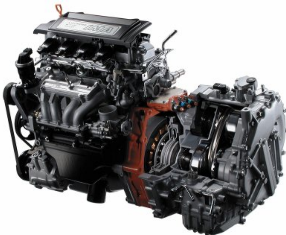
Obr. 6-12: Hybridní pohonné ústrojí automobilu Honda Civic Hybrid [62]
