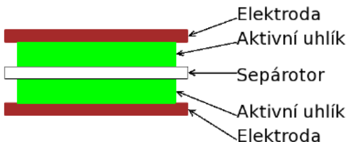
Obr. 5-21: Schéma superkondenzátoru [8]
