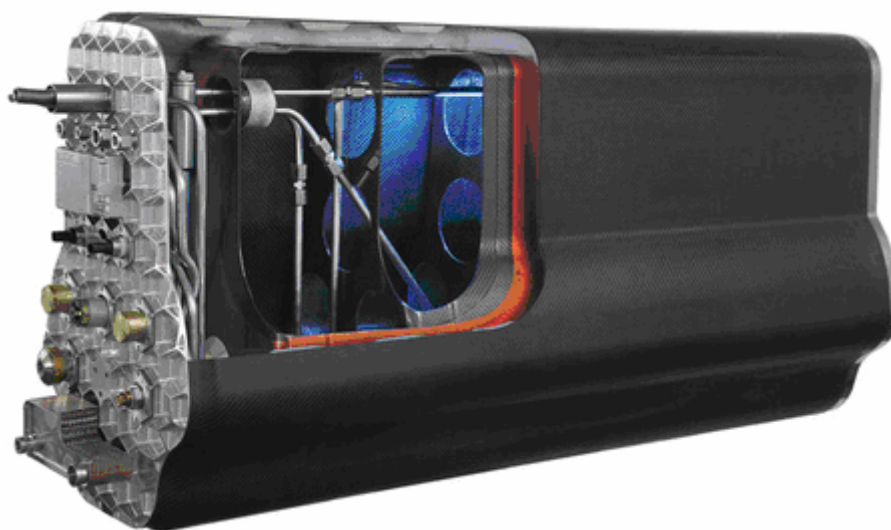
Obr. 4-8: Nádrž na zkapalněný vodík používaný automobilkou BMW [53]
