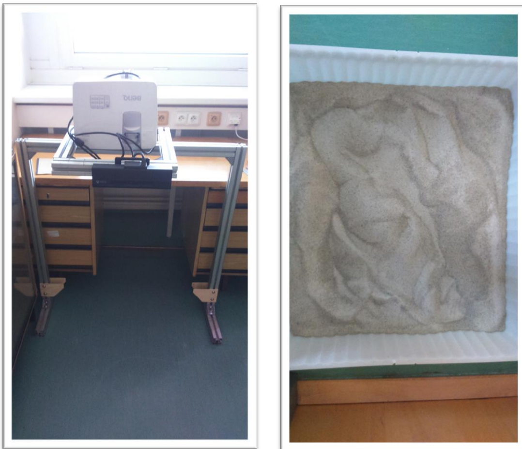
Obrázek 3.3 Nosná konstrukce s projektorem a Kinectem + krabice s pískem.
