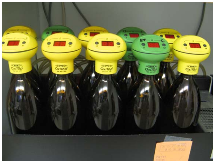
Obrázek 24: Inkubace vzorků s měřicím zařízením OxiTop®.
