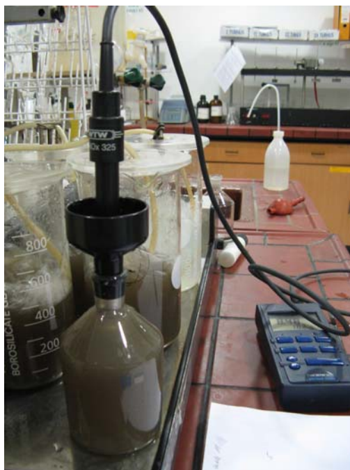
Obrázek 23: Měření spotřeby kyslíku kyslíkovou sondou.
