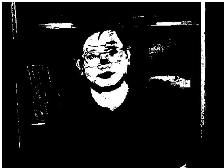
obr.č.12 – binární obraz bez filtrace
