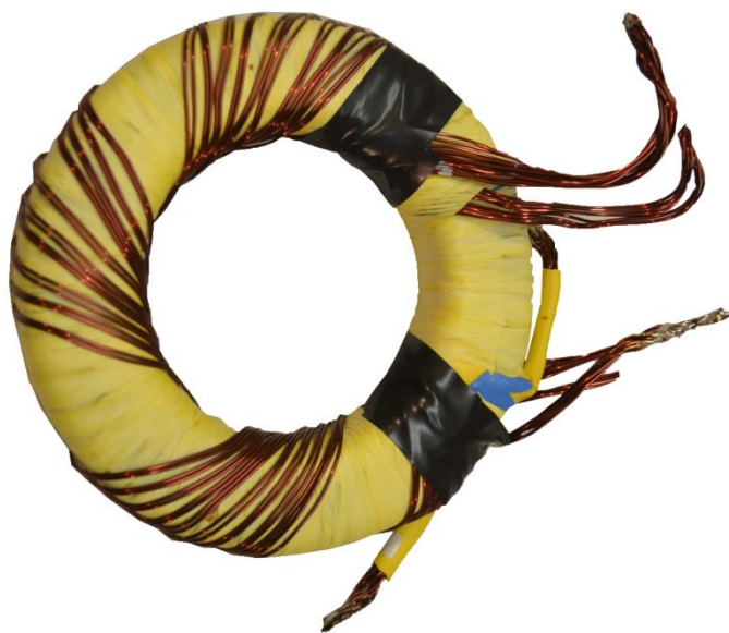
Obr. 9.2: Sekundární vinutí výkonového transformátoru, zobrazena je část vinutí, kde je ještě možné rozeznat počet závitů.
